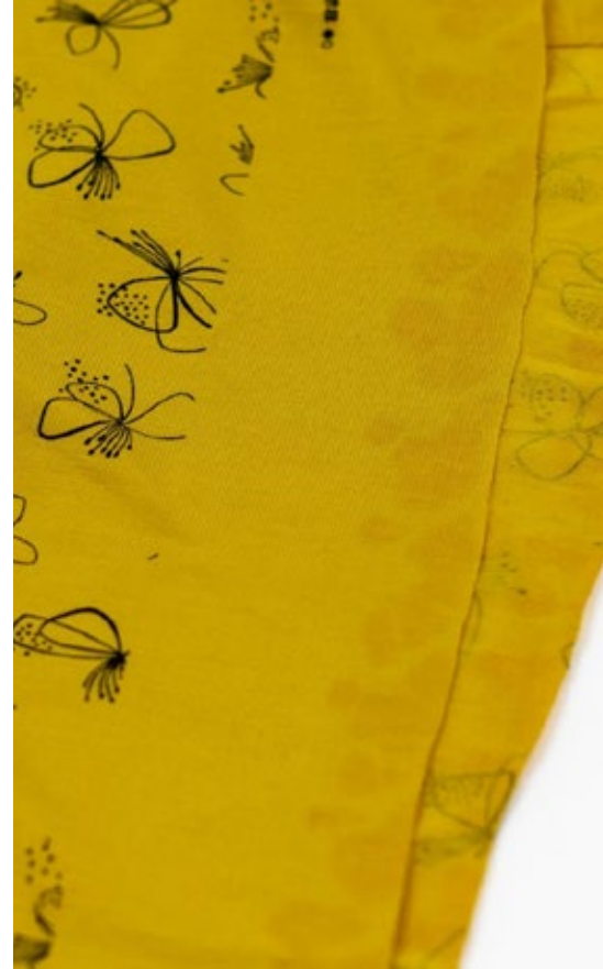
Beispiel für Klebekante beim aufgeschnittenen Strickschlauch.
